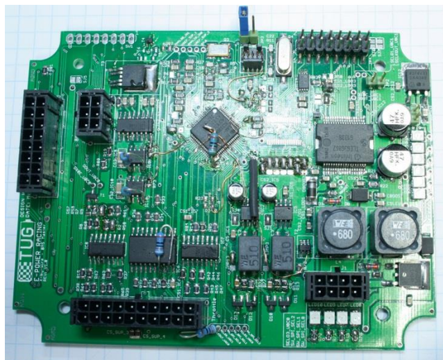
Abbildung 5.1: "gepatchte" Platine vor der ersten Revision
